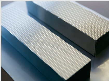
PLBv2の転造用ダイス。ねじメーカーにレンタルする
